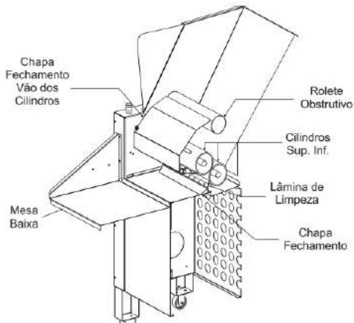
Figura 1: Representação esquemática do cilindro sovador.
