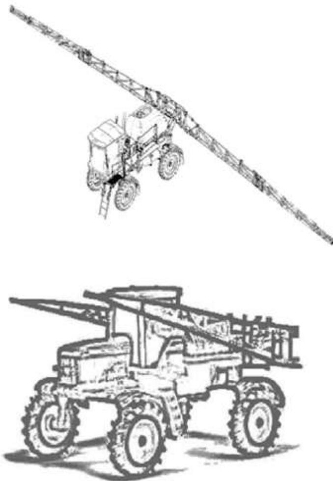
Pulverizador tracionado: implemento agrícola que, quando acoplado a um trator agrícola, pode realizar a operação de aplicar agrotóxicos.
